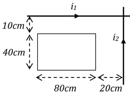
**Ejercicio 2:** una bobina de 50 espiras se halla próxima a dos conductores por los que circulan corrientes de intensidades  $i_1=50\text{A}$  e  $i_2=200\text{A}$ , respectivamente. La bobina y los conductores son coplanares. Calcule:
