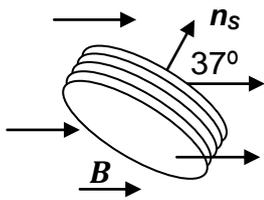
**Ejercicio 9:** La bobina de la figura, de radio  $r = 10\text{cm}$ , tiene 5 vueltas y se halla inmersa en un campo magnético espacialmente uniforme  $\vec{B}_{EXT} = \alpha t^2 \hat{e}_x$  ( $n_s$  representa la normal a la superficie de la espira). Para  $\alpha = 0,04 \text{ Tseg}^{-2}$ , calcule la fem inducida en la bobina como función del tiempo.
