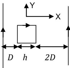
**Ejercicio 18:** suponga que se arregla la configuración de corrientes y espiras del ejercicio anterior de la forma en que indica la figura. Discuta y justifique si alguno de los resultados cambia. En particular, analice el valor del coeficiente de inducción mutua entre los alambres y la espira si las corrientes en este arreglo fueran antiparalelas.
