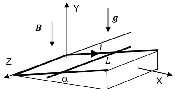
a) calcule el valor de la intensidad de corriente de modo tal que la barra permanezca en equilibrio; b) si la corriente fuera de 2A, calcule la aceleración de la barra a lo largo del plano inclinado.
