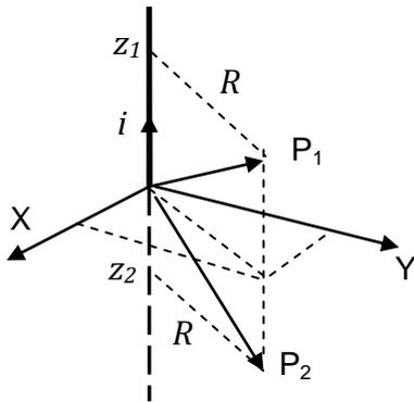
**Ejercicio 15:** la figura muestra un alambre recto semiinfinito circulado por una corriente de intensidad  $i$ . Por comodidad se ha hecho coincidir al cable con el semieje positivo Z. Calcule el campo magnético generado por este alambre en puntos a una distancia  $R$  enfrentados al semieje que contiene al cable (por ejemplo, el punto  $P_1$  de la figura) y puntos a una distancia  $R$  enfrentados al semieje que no contiene corrientes (como el punto  $P_2$  de la figura).
