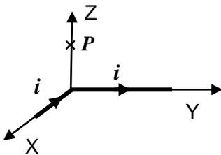
**Ejercicio 19:** La figura muestra un sector de un conductor recto y de gran longitud, por el que circula una corriente continua y estacionaria de intensidad  $i = 8$  A, y que está doblado en ángulo recto. Halle el vector inducción magnética en el punto  $P$  de coordenadas  $(0; 0; 0,5$  m) generado por la corriente  $i$ .
