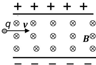
**Ejercicio 3:** una carga  $q > 0$  ingresa a la región entre las placas de un capacitor plano. El espacio entre las placas es vacío, y en él existe un campo magnético uniforme  $\mathbf{B}$ , como indica la figura. Discuta cuáles son las tres afirmaciones correctas
