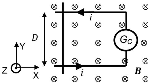
**Ejercicio 7:** un alambre metálico de masa  $m$  desliza sin fricción sobre dos rieles metálicos separados una distancia  $D$ . El sistema está alojado en una región del espacio en la que existe un campo magnético uniforme  $B$ . Entre los rieles se establece una corriente  $i$  por medio del generador de corriente  $G_C$  que se muestra en la figura. Halle la expresión del vector velocidad del alambre en función del tiempo sabiendo que en  $t = 0$  el alambre está en reposo.
