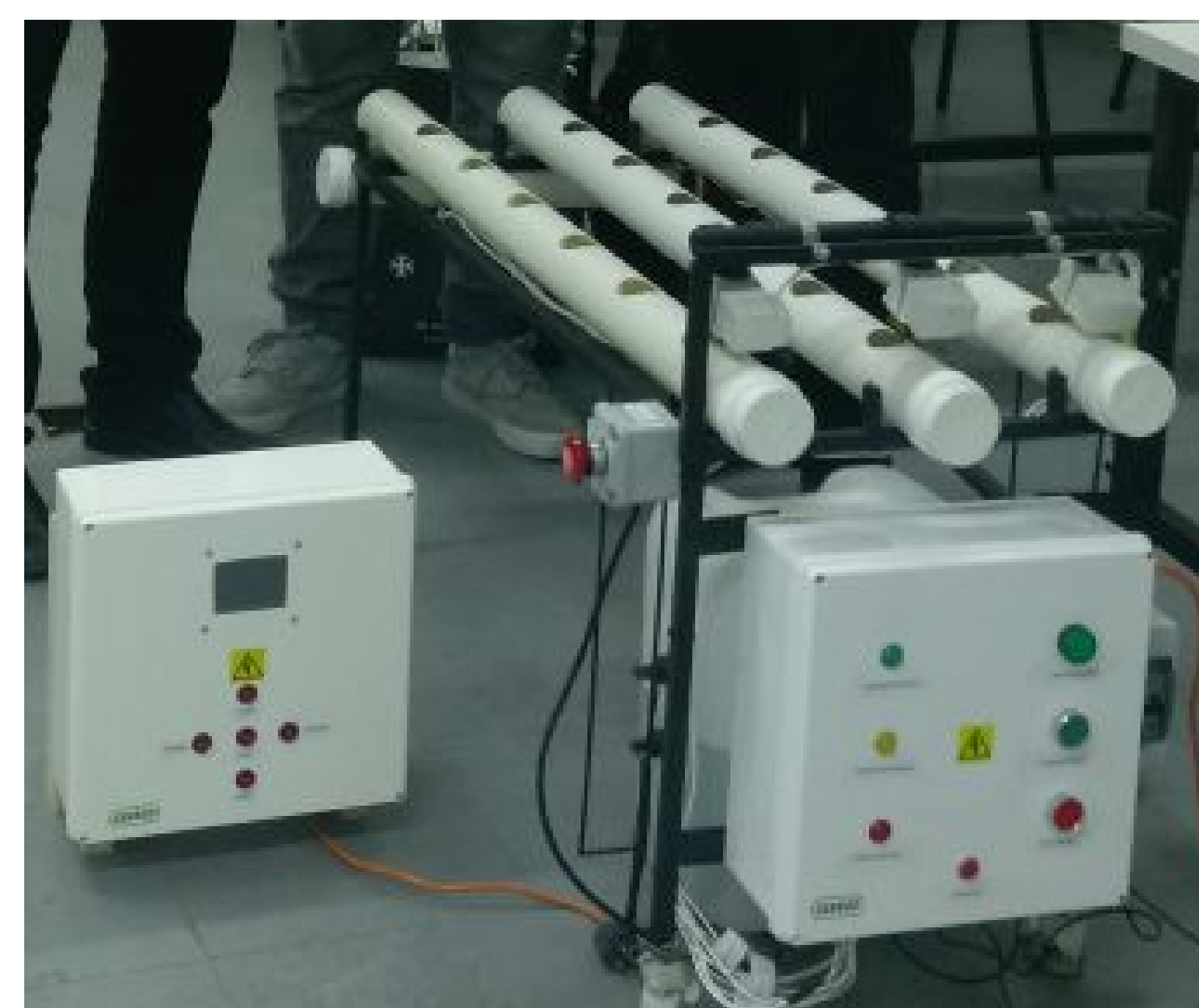
Figure 3: Modulo Central a la izquierda y Módulo de Medición instalado en mesa de cultivo a la derecha.
