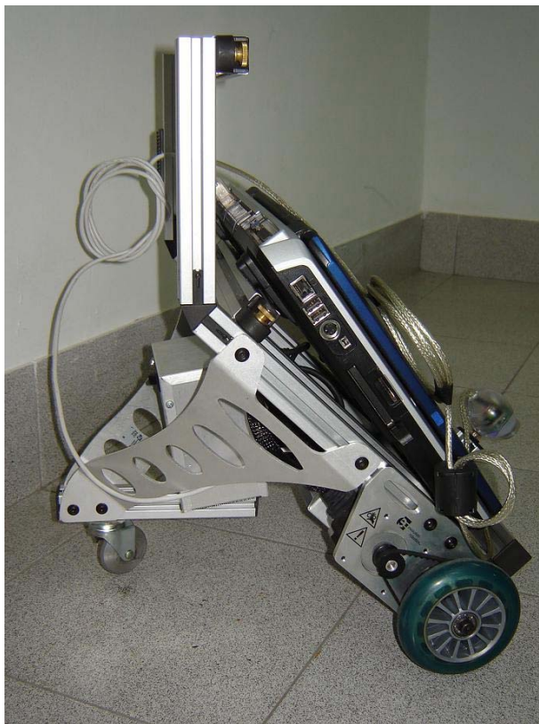
Figura 3 Armado del robot ER1. Vista lateral.
