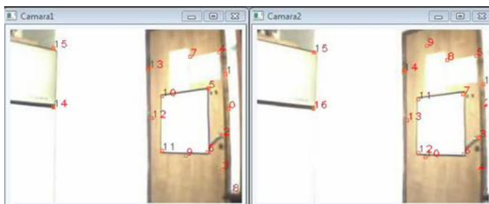
Figura 9 – Muestra de hallazgo de puntos característicos sobre la puerta del laboratorio del grupo GIAR
