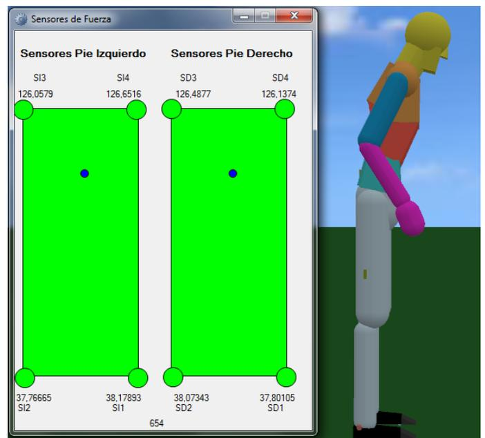
Fig. 14. Vista de sensores de fuerza con una inclinación hacia adelante, valores en Newtons
