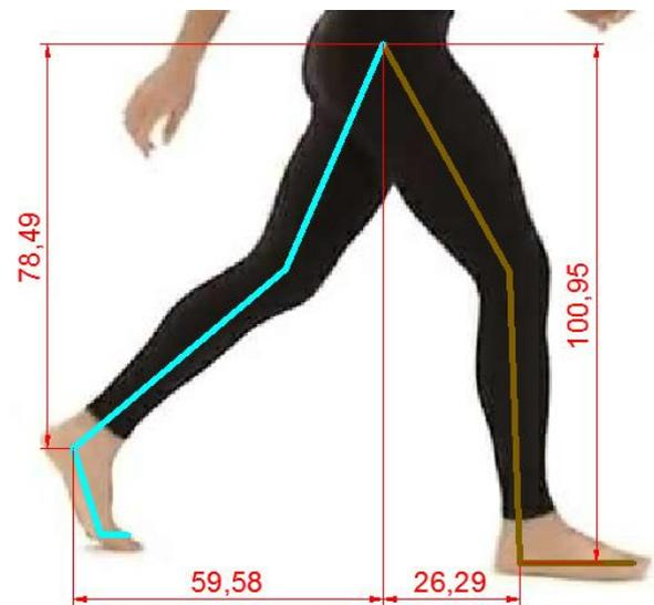
Fig. 7. Posiciones del pie en imágenes representativas al ciclo de marcha, las medidas no tienen unidades, se escalan usando medidas reales.
