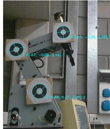
Fig. 4. Sistema de localización externa calculando la posición 3D de las tres circunferencias de la imagen.
