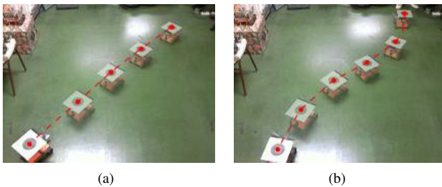
Figura 4. Trayectoria en línea recta y en zigzag utilizando el robot Exabot.
