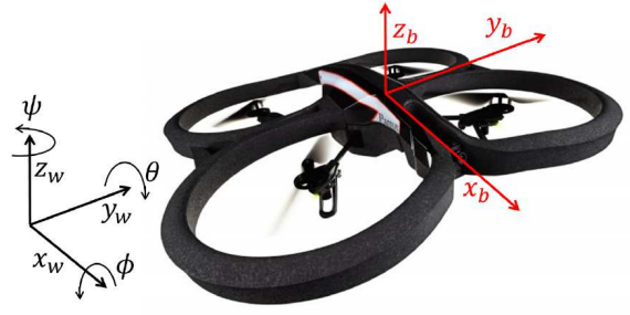
Fig. 2. Ar.Drone en su versión 2.0 y sus correspondientes sistemas de referencia móvil asociado al helicóptero \{b\} , y el sistema de referencia inercial \{w\} .
