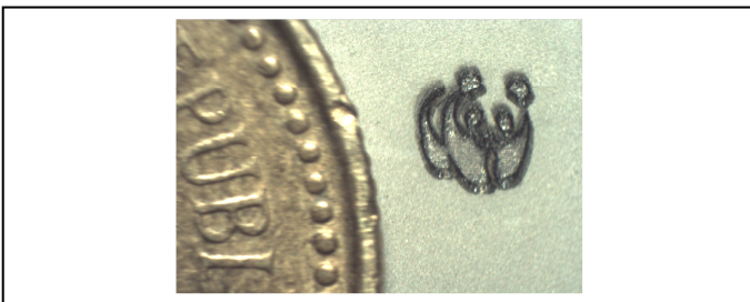
Fig. 8. Imagen de un oso panda realizada con micromaquinado láser. El grabado se compara con una moneda de 5 centavos (pesos argentinos).
