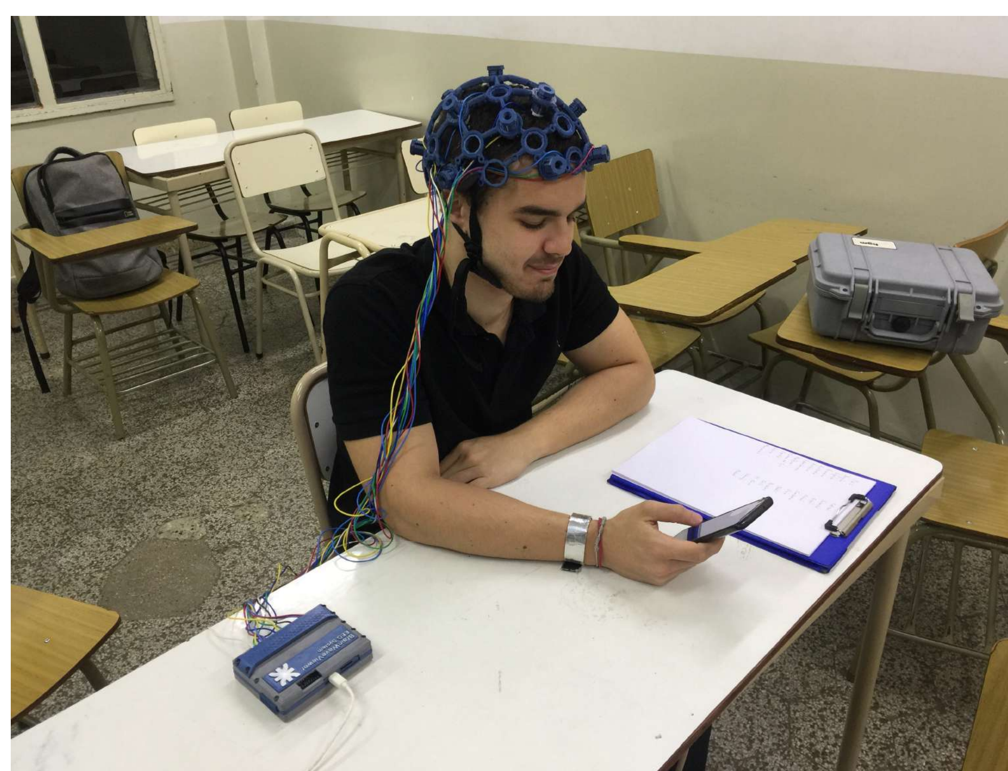
Figura 5: Equipo siendo utilizado con la aplicación "NeuroCare" (hecha por estudiantes de Ingeniería en Sistemas).
